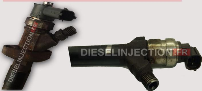
**Corps de l'injecteur ou circuit de carburant endommagé**
