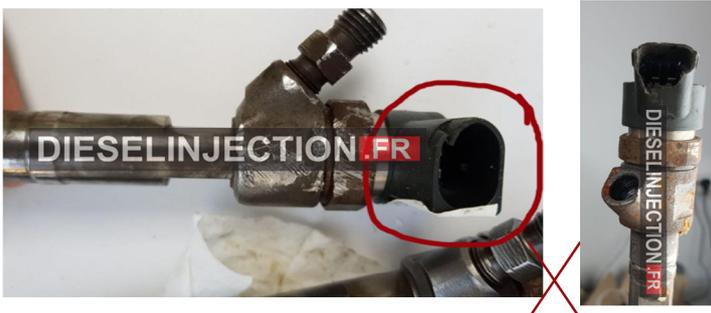
**Injecteur endommagé lors du démontage / écrou endommagé**
